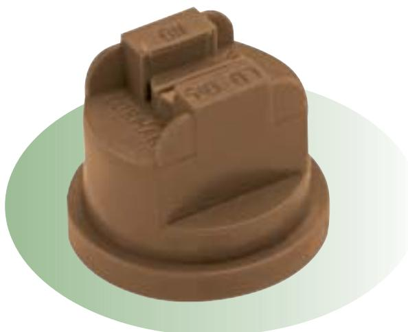
Lo-Drift (LD) uma ponta original para a redução de deriva, produzindo significativamente menos gotas finas do que uma ponta leque comum. A construção especial em duas partes inclui um pró-órficio removível, que se encaixa diretamente no corpo de bico - isto reduz significativamente o nômero de gotas propensas à deriva. Excelente para a aplicação de herbicidas pré-emergentes e pós-emergentes sistêmicos, quando utilizado como um jato médio, ideal para fungicidas.
