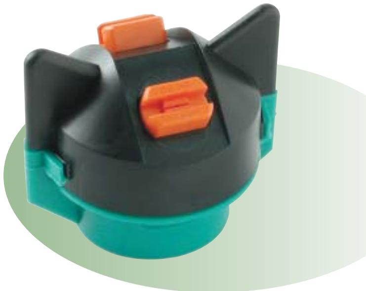
A capa dupla (TwinCap) permite a variação do volume de gema e do tamanho das gotas por meio de duas pontas acopladas em seu interior, sendo ainda capaz de manter a taxa de aplicação. Ensaios têm mostrado a eficiência deste produto na aplicação de fungicidas para a ferrugem da batata e de fungicidas e herbicidas em geral nas culturas vegetais.
