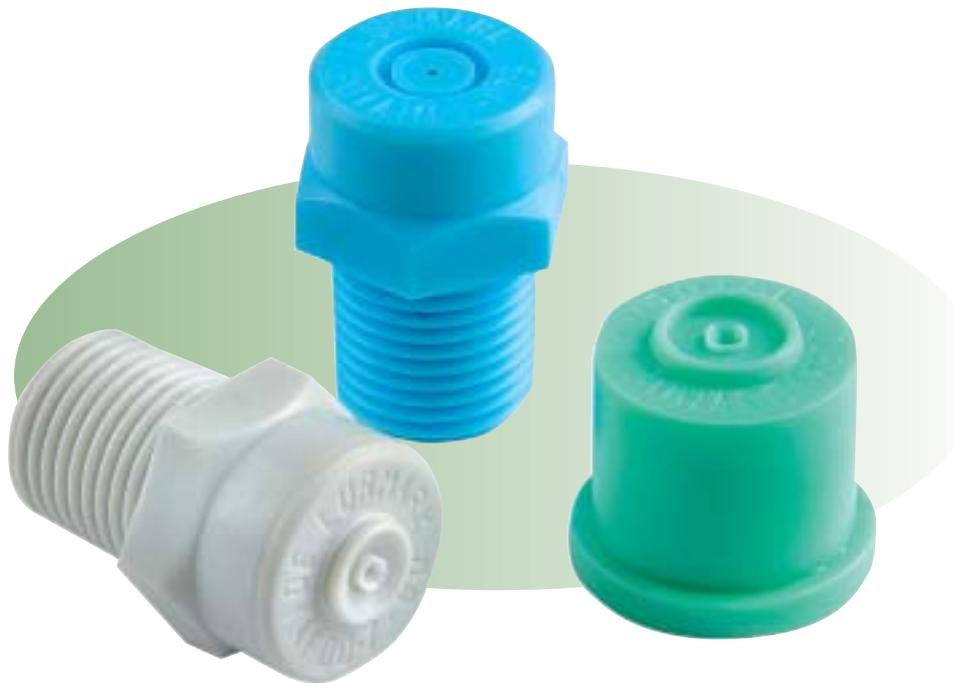
A série *Mist* produz gotas extremamente finas (inferiores a 50 micr metros) sendo as pontas satisfatórias para procedimentos de umidificação de ambientes e resfriamento evaporativo. Uma gama de pesticidas, desinfetantes e agentes controladores de odor podem ser aplicados através das pontas da série *Mist*, o que as torna ideais para a utilização em silos e armazéns, currais e casas de vegetação.
